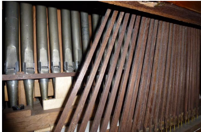
Metalen Hess-pijpjes (op de voorgrond de stekermechaniek)
