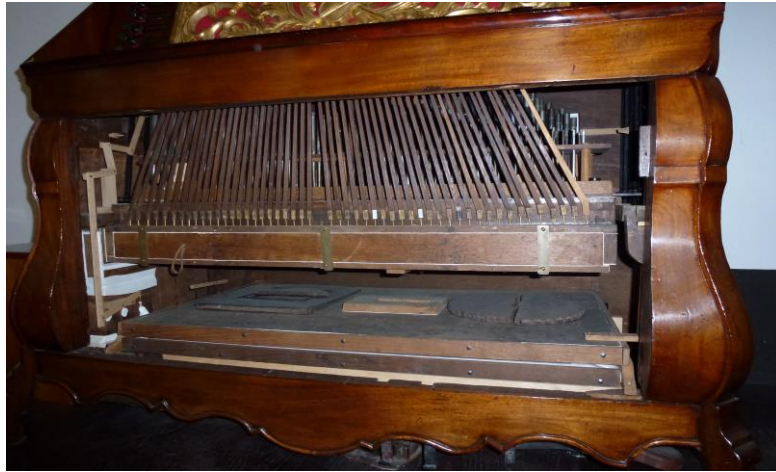
De onderkast met (van onderen af gezien) de magazijnbalg, de windlade en de toetsmechaniek (met daarachter de metalen pijpen)
